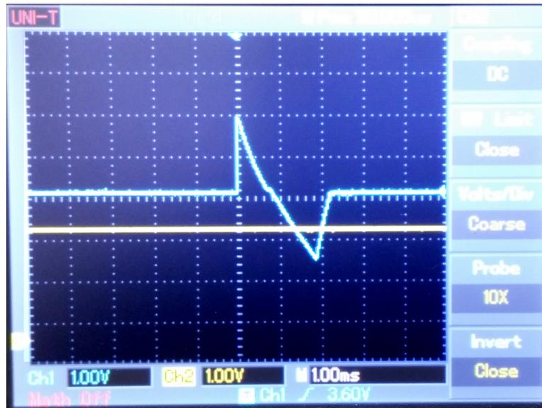
Figura 3.15: Sinal de controle recebido através do rádio com pulsos com duração de 2ms, saída do integrador varia de 5.44V a 1.92V, atingindo valor inferior ao limiar de comparação estabelecido, 2.68V. Saída do integrador corresponde à linha superior na tela do osciloscópio mostrada nesta figura e o limiar de comparação corresponde à reta constante, linha inferior.
