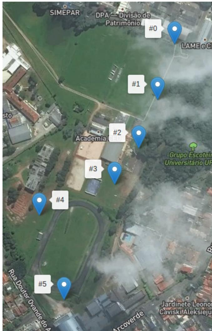
Figura 5.1: Pontos onde os testes foram realizados. O computador de campo ficou fixado no marcador com etiqueta "#0" e a plataforma foi posicionada em outras marcações para realizar a comunicação. Em cada ponto foi testado o envio de dez mil pacotes e esse processo foi repetido dez vezes a cada marcação para identificar ou não uma instabilidade na comunicação. Os pontos marcados estão a uma distância de 100 metros da base em "#1", 200 em "#2", 300 em "#3", 400 em "#4" e 500 metros no ponto "#5".
