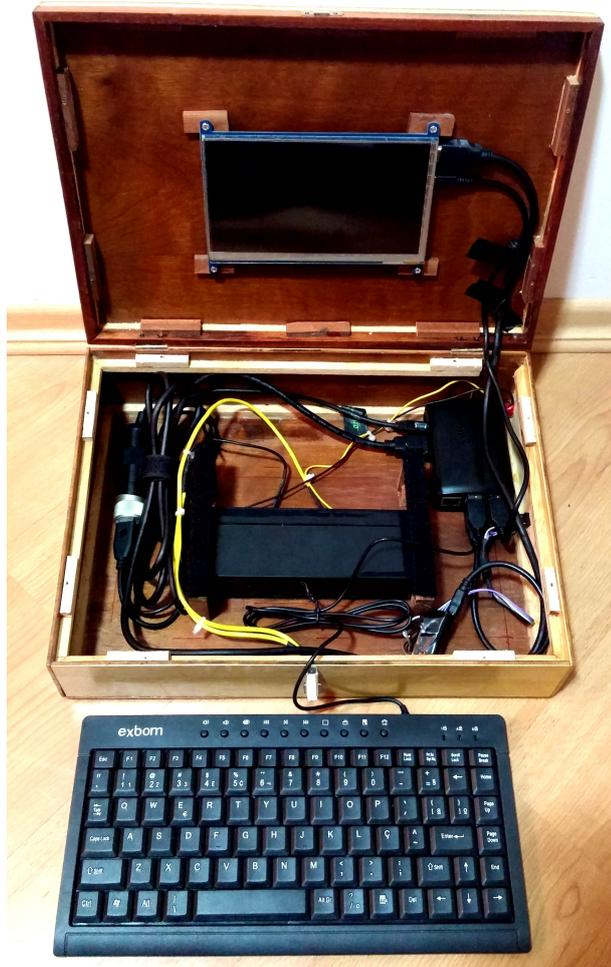
Figura 4.20: Computador de campo (montagem e organização dos componentes).
