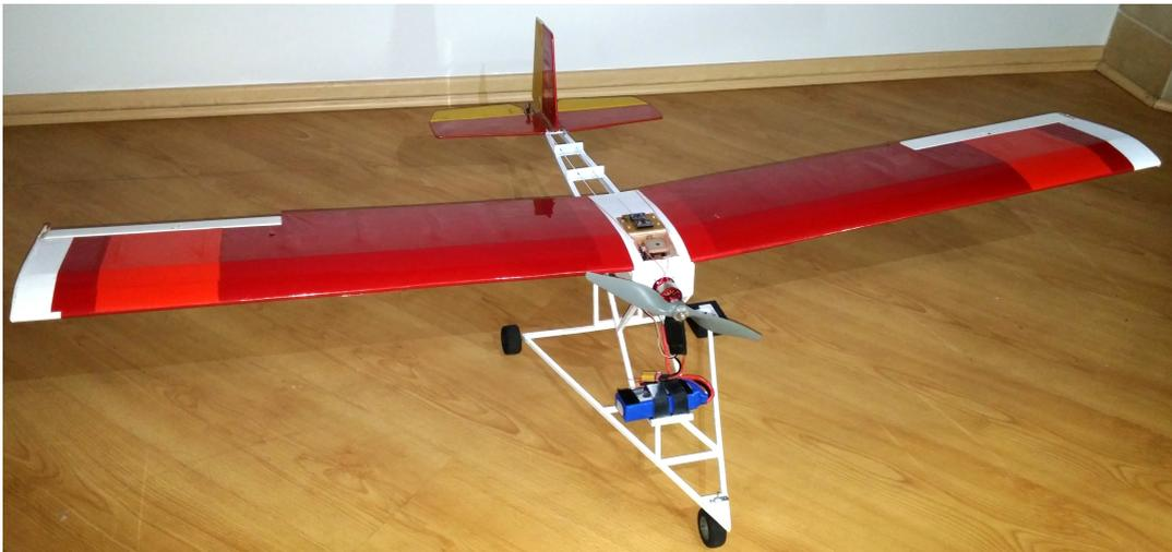
Figura 4.11: Visão frontal do aeromodelo em sua totalidade. Aqui pode-se notar que o centro da asa foi modificado para receber dos sensores.
